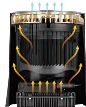
● -25℃~40℃までの動作が確認されており、埋め込みボックス内でも、灯具と電源ボックスの放熱が効率よくトリムに伝達される設計になっています。
