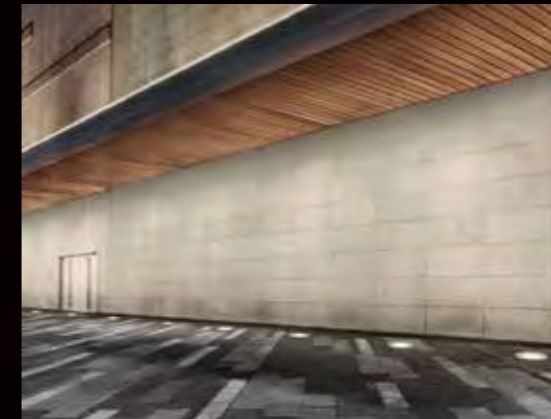
●連続した壁面を均一に照射した例。壁面からわずか 750mm の位置に設置しながら、ムラの少ない面照射を実現しています。 : Asymmetric Wallwash スモールフロストレンズ 3500K
