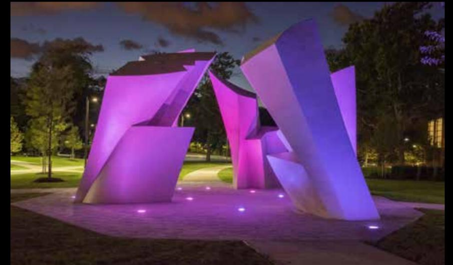
この彫刻は、アメリカの著名な建築家でクリーブランド出身のフィリップ・ジョンソンによって制作され5つのなだらかにねじれた石碑で構成されています。イースト・ベル・パークに移設された際、Ron Friedman Lighting Design により作品を一層引き立たせる照明が計画されました。複雑な形状を最小限の器具台数で適切に照らし上げるため、3D デジタルデータを用い、Lumenbeam Inground が採用されました。このシリーズは35°×90°という精度の高い配光角を持ち、さらにチルト機能により微妙な角度調整ができるため、必要な場所を正確に狙うことができる新しいシリーズです。季節や地元のイベントをカラー照明で表現することや、白色の光で静かに照らし上げることによりその芸術性を欠かさずに輝かせることに成功しています。
