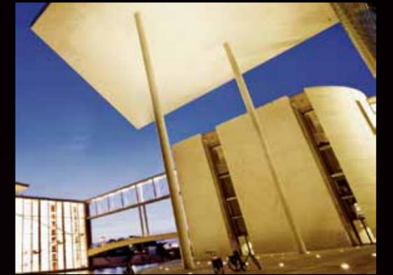
●15m の高さのキャノピーを地上から照射した例。Narrow Spot 10° の選択により、訪れる人々にグレアを感じさせることなく、キャノピーの反射光を効率よく照射しています。
