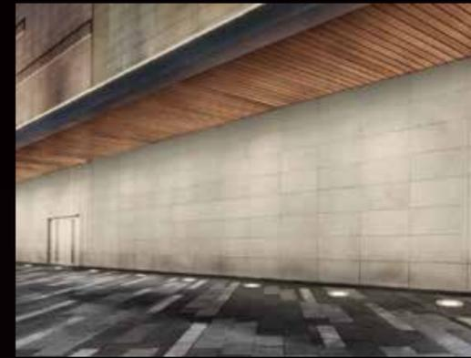
●連続した壁面を均一に照射した例。壁面からわずか 750mm の位置に設置しながら、ムラの少ない面照射を実現しています。
